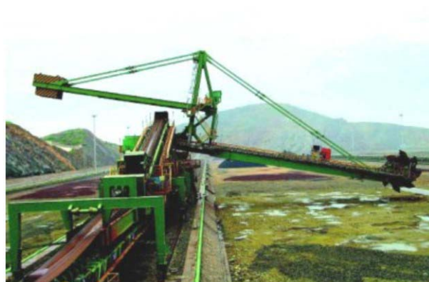
Foto 1.4-9 - Empilhadeira e recuperadora de granéis sólidos típica
