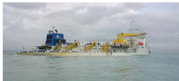
Foto 1.4.-6 - Dragagem Hopper, autotransportadora, em operação em Barra do Açú
